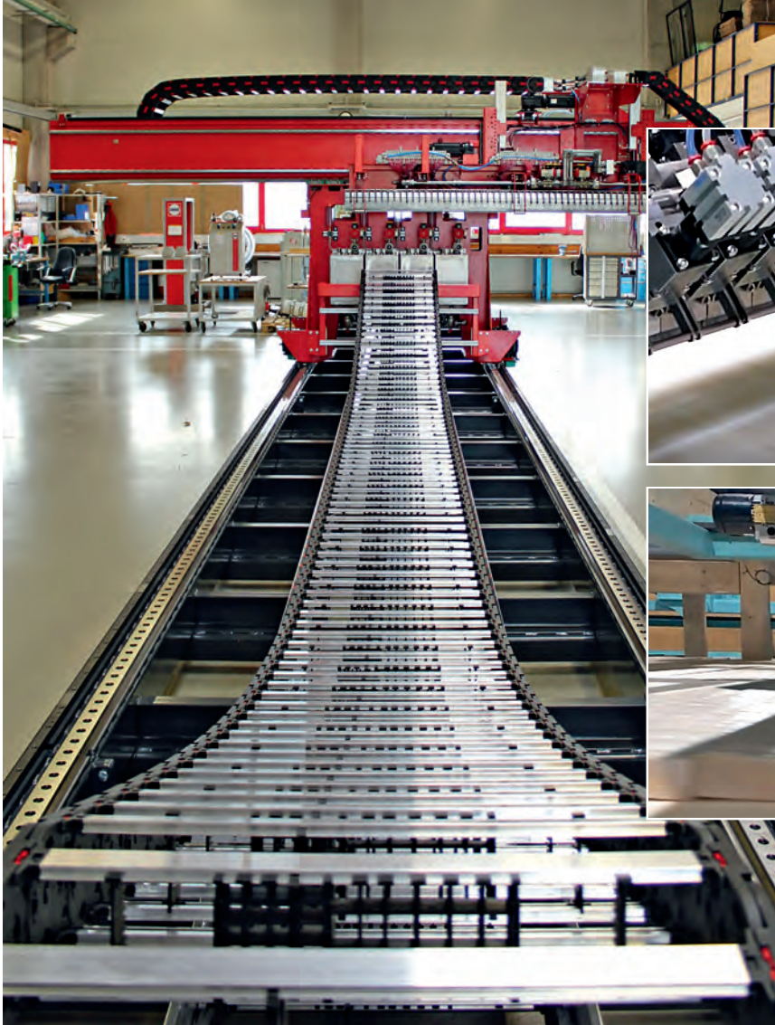
Links: Riesige Schleppketten versorgen den Auftragskopf mit Energie und Klebstoff selbst bei hohen Arbeitstakten
