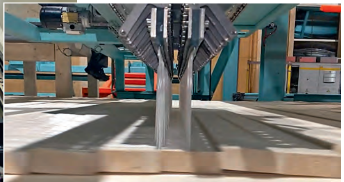
Bei Splitkon AS (MUF-Kleberauftrag) müssen hochsäurefeste Komponenten eingesetzt werden. Große Varianz an Auftragsmengen und Rezepturen sind die Regel. Kalte Presse und kurzer Zyklus sind gefordert
