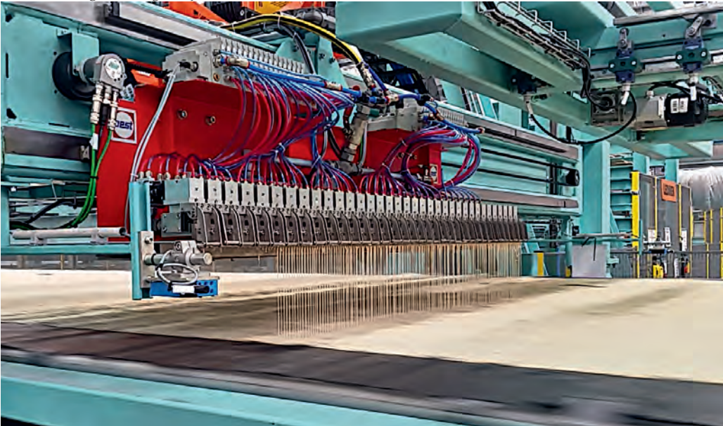
Oben: Oest-Technologie in Aktion, Kern-Kompetenz: So genannte Klebstoffraupen werden in gleichmäßigen Abständen auf die darunter liegende Holzfläche gelegt. Alles bei Vorschub bis zu 120m/min!
