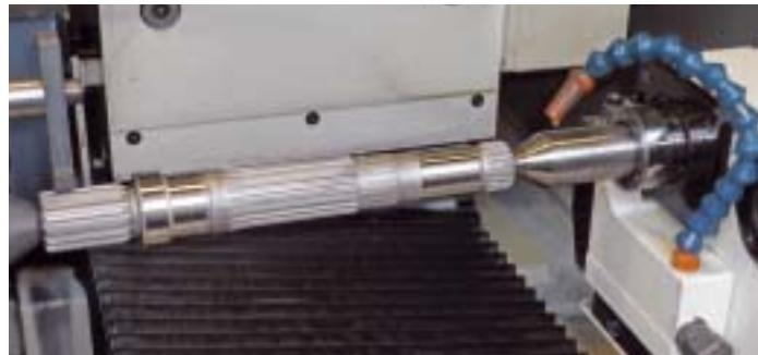
Gehärtete Antriebswelle beim Schleifprozess
